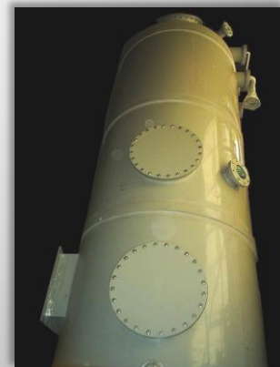
Lavador de Gases Torre Empacada, 14,000 acfm
