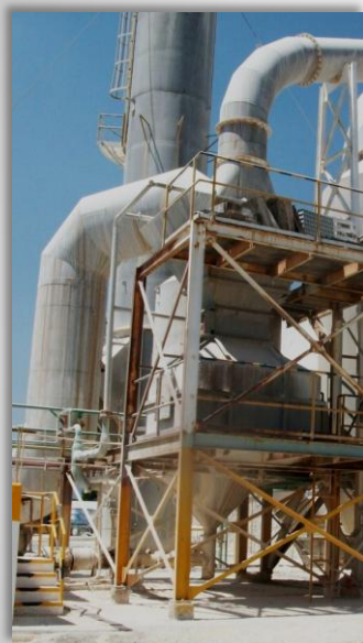
Lavador de Gases Venturi Variable, 45,000 acfm
