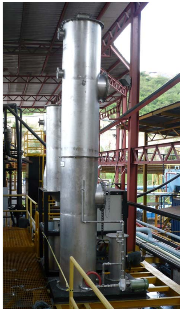
Torre empacada para captación de Mercurio Elemental (Hg 0 ) Fabricada completamente en Acero inoxidable. Opera un volumen de 1,500 acfm.
